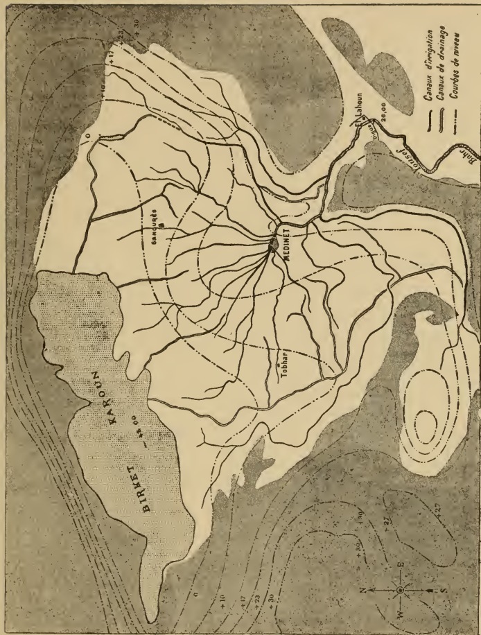
FIG. 47. — Le Fayoum. Courbes de niveau. Réseau d'irrigation et réseau de drainage. 1 : 800 000.
